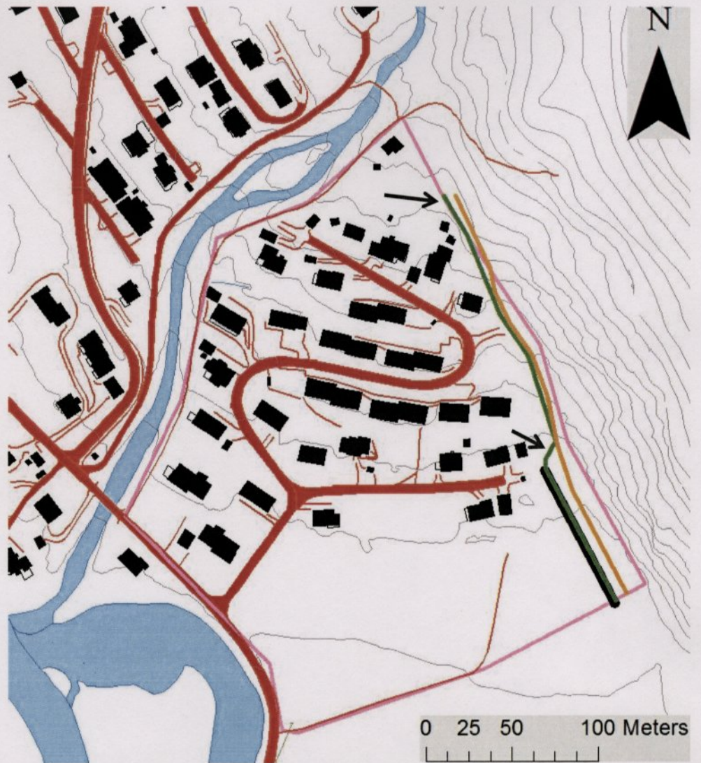
Fig. 20 Faregrenser for dimensjonerende skredhendinger etter sikringstiltak (svart strek=voll) med årleg sannsyn 1/1000 og 1/5000 (grøn strek). Skredhendinger med årleg sannsyn 1/100 er merkt med brun strek. Raude piler indikerer området som må sikrast med voll eller fanggerde mot steinsprang. Området mellom dei svarte pilene indikerer område som må sikrast med steinspranggroft eller voll minimum 5 meter frå start av fjellside, eller fanggerde.
