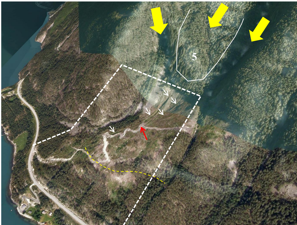
Fig. 9 Ortofoto fra Norgei3d der skredløpene er markert med hvite pilsymbol. Legg merke til de markerte ryggene (levéene) på hver side av skredløpene. Vi ser også tydelig steinspranguren ved foten av nedre løsneområde for steinsprang. Ved den røde pilen kan skred med større volum forlate skredrennen. Område 5 er markert med hvitt omriss. Ca. avgrensning av skredavsetninger er markert med gulstiplet linje, planområdet med hvitstiplet linje.
